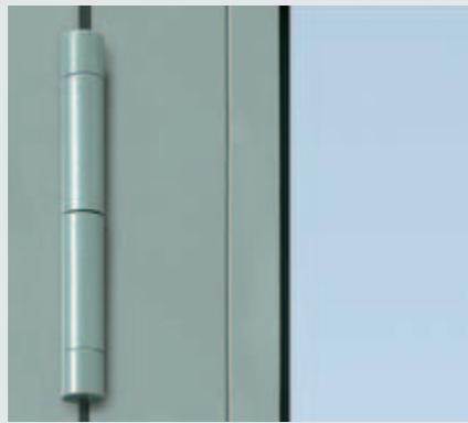
Bei den schlanken S-Line-Profilen bietet sich als Alternative auch das schmale Stahl-Rollenband als Anschweiß- oder Anschraubversion (Drehpunkt 12 mm) an. Es betont die Vertikale und ist in der gleichen Oberfläche wie die Tür oder in Edelstahl lieferbar.
