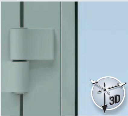
Das serienmäßige 3D-Band für T30 und RS-Türen ist dreidimensional verstellbar, wahlweise mit einem Drehpunkt von 20 oder 36 mm. Dieses Aluminiumband liefern wir eloxiert, pulverbeschichtet in allen Farben oder in Edelstahl-Finish.
